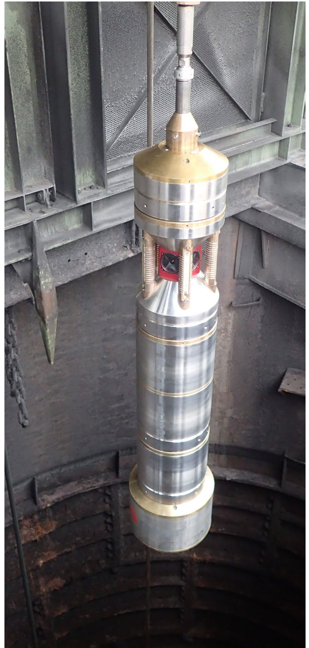
DMT – Seilgeführtes 3D-Schachtscanningsystem
