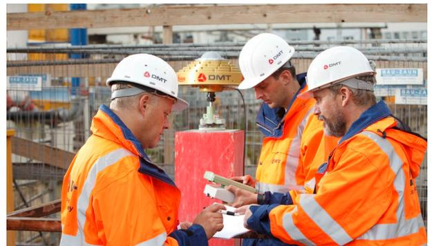
Erstellung eines lokalen Grundlagennetzes mit Hilfe hochpräziser GNSS-Messungen
