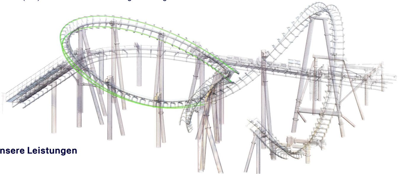
3D Punktwolke: as-built Dokumentation einer Achterbahn
